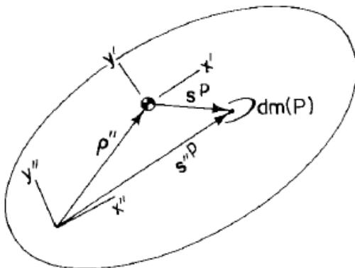
$$\begin{aligned} J'' &= \int_m (\mathbf{s}''^P)^T \mathbf{s}''^P dm(P) \\ &= J' + m (\boldsymbol{\rho}''^T \boldsymbol{\rho}'') \end{aligned}$$
