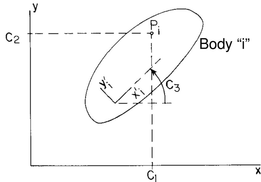
$$\mathbf{r}^{P_i} = \mathbf{r}_i + \mathbf{A}_i \mathbf{s}'^{P_i} \quad \Rightarrow \quad \mathbf{r}^{P_i} = \begin{bmatrix} x_i \\ y_i \end{bmatrix} + \begin{bmatrix} \cos \phi_i & -\sin \phi_i \\ \sin \phi_i & \cos \phi_i \end{bmatrix} \begin{bmatrix} x'_i \\ y'_i \end{bmatrix} \quad 12$$
